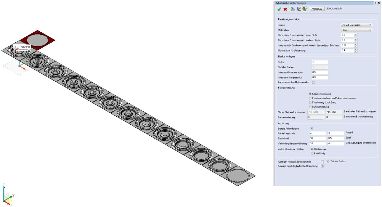
In der Eingabemaske kann jetzt der Inkrementwert des Stempel- und Matrizenradius für jeden Schritt einzeln eingestellt werden.
